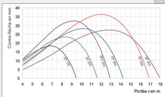
Illustration 44. Contre-flèche à réaliser en fonction de la portée et de la typologie du hourdis.
