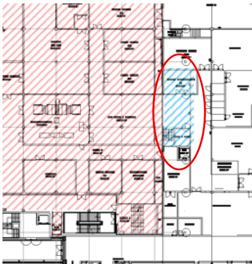
Illustration 20. Emplacement mezzanine et monte-charge proposé Source : Aertec / BAG
