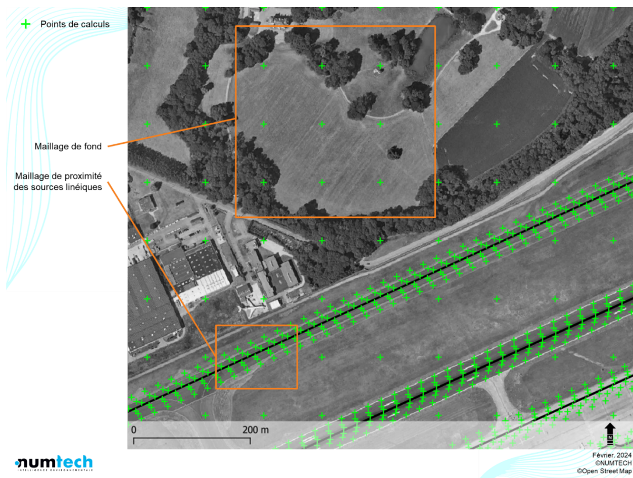
Figure 20 – Illustration du maillage de points de calculs utilisé pour la modélisation
