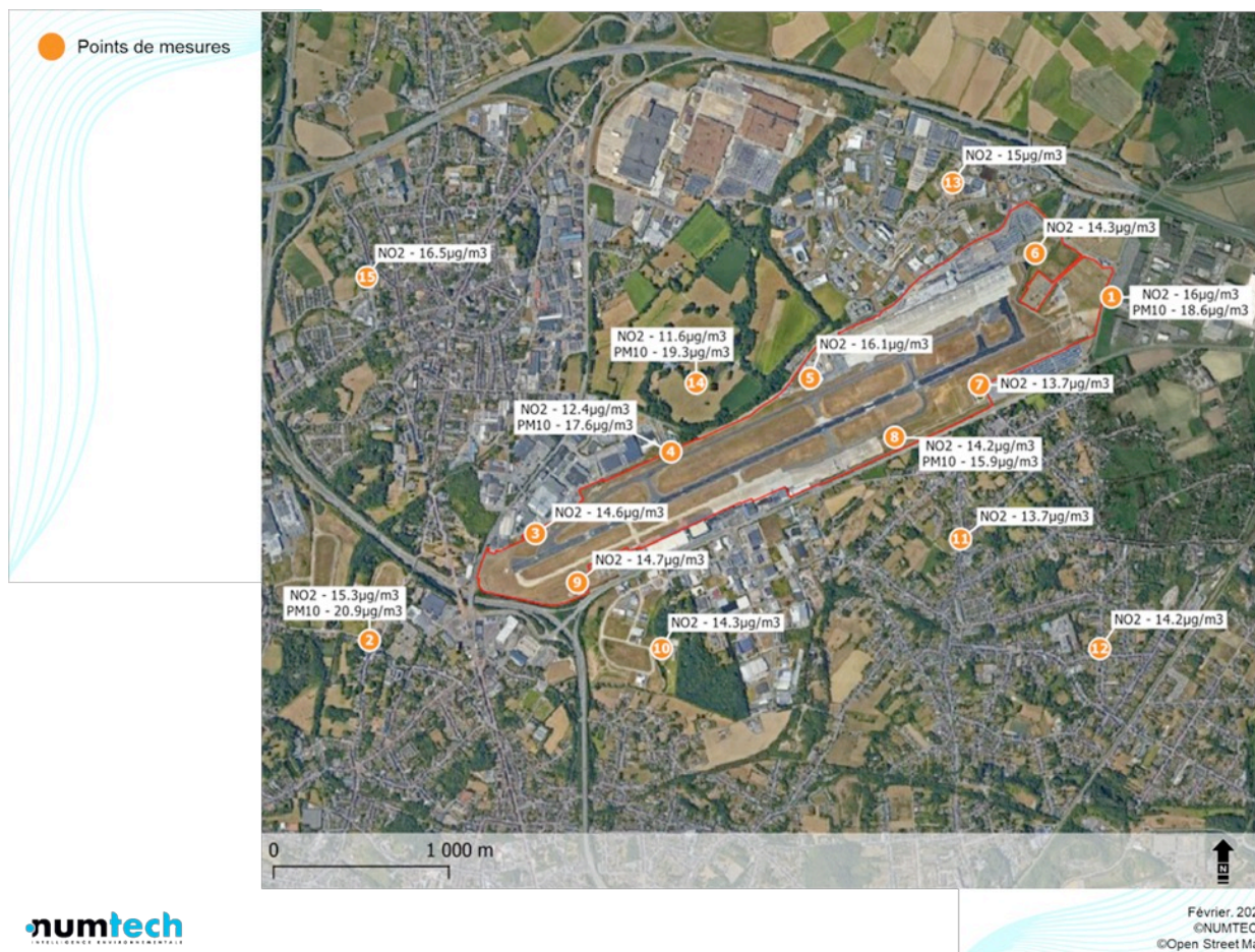
Figure 21 - Résultats de la campagne de mesures par tubes passifs dans l'environnement de l'aéroport
