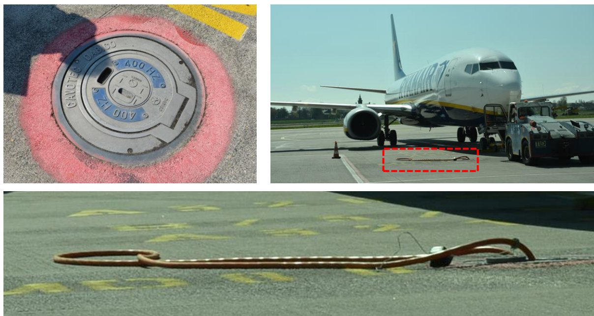
Figure 5 : Alimentation par GPU au sol (ARIES, 2023)
